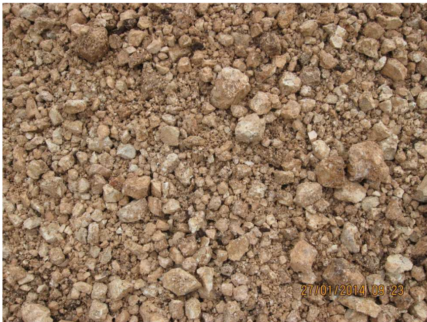
Fig. 4: lo scavo n. 1 e il terreno di risulta (accumulo di paleofrana da 8,5 metri di prof.)
